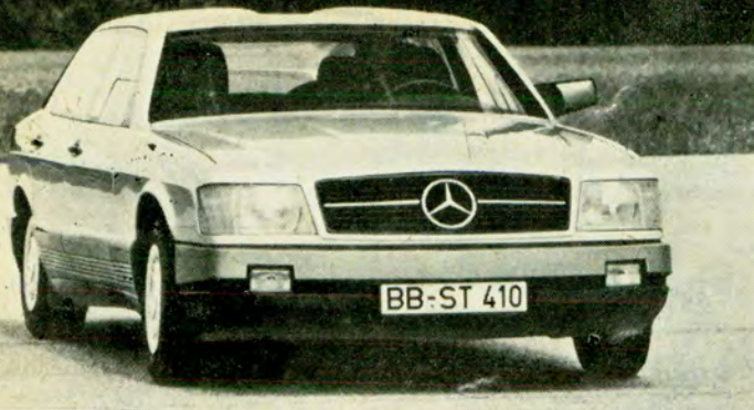
En el Mercedes-Benz "Car 2000" su motor a turbina de cerámica eroga 128 CV.
